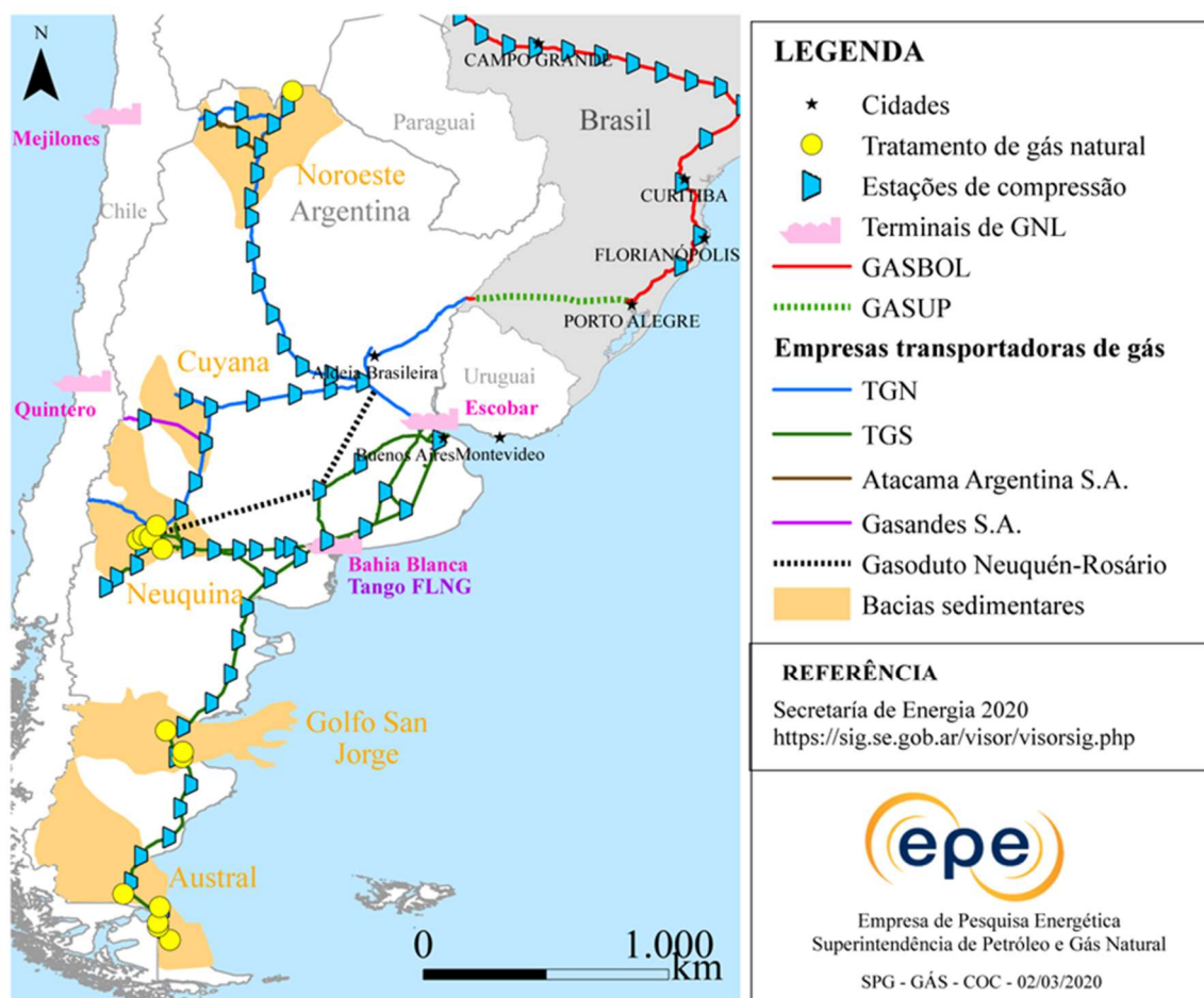
Figura 5 – Malha de gasodutos e outras instalações na Argentina e no Sul do Brasil
